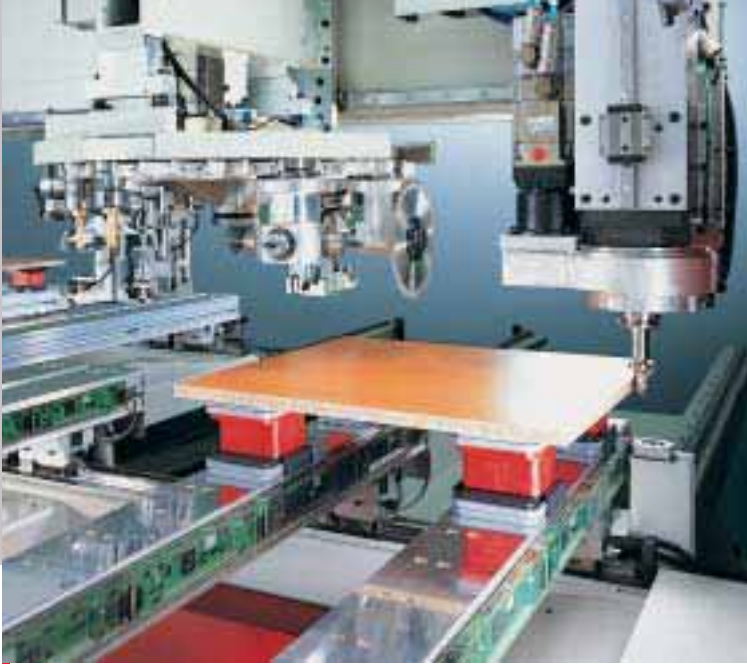
18-fach Werkzeugwechsler und Hauptspindel
