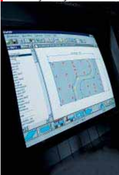
IMAWOP-Steuerung zur automatischen Positionierung der Sauger
