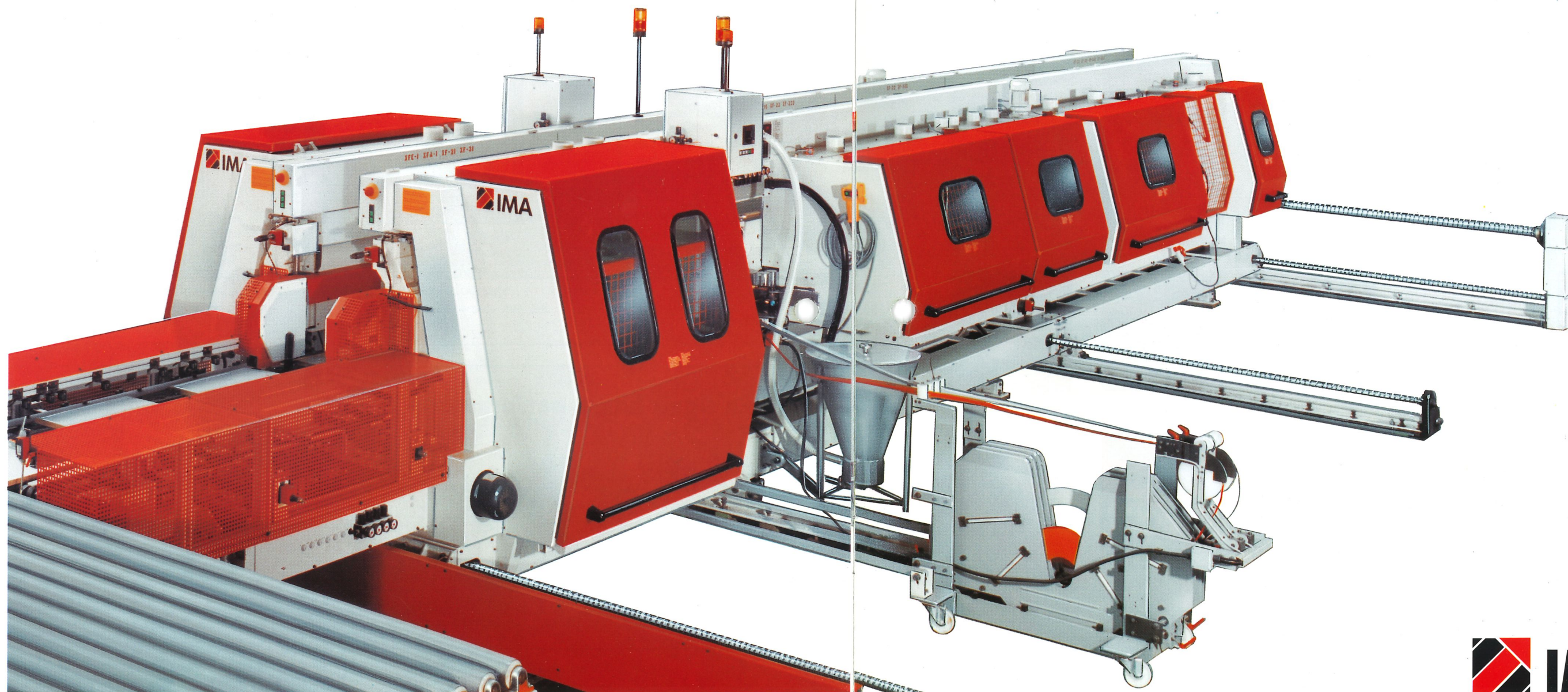
Dispositif d'introduction COMBIMA II transfère des pièces sur un niveau (option sur 2 niveaux).
