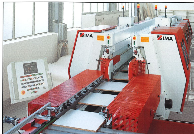
Dispositif d'introduction COMBIMA II transfère des pièces sur un niveau (option sur 2 niveaux).
