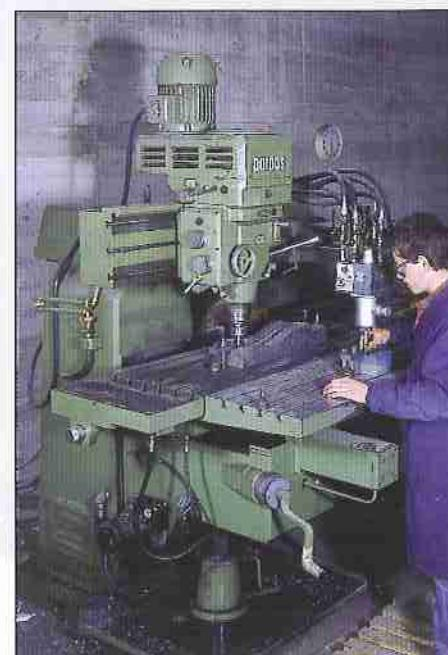
Gli stampi, ricavati da acciai speciali utilizzando tecniche e macchinari modernissimi, sono ricoperti con cromo a forte spessore per una maggiore durata e finiti accuratamente a mano, è possibile in tal modo realizzare ogni tipo di fregi e cornici, sia da catalogo che da disegno.
