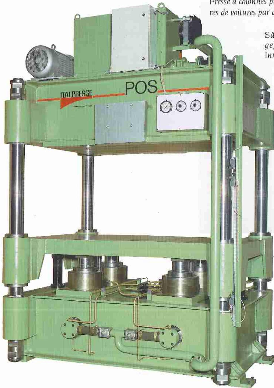
Pressa a colonne per il rivestimento con tessuti di parti interne autovettura.
