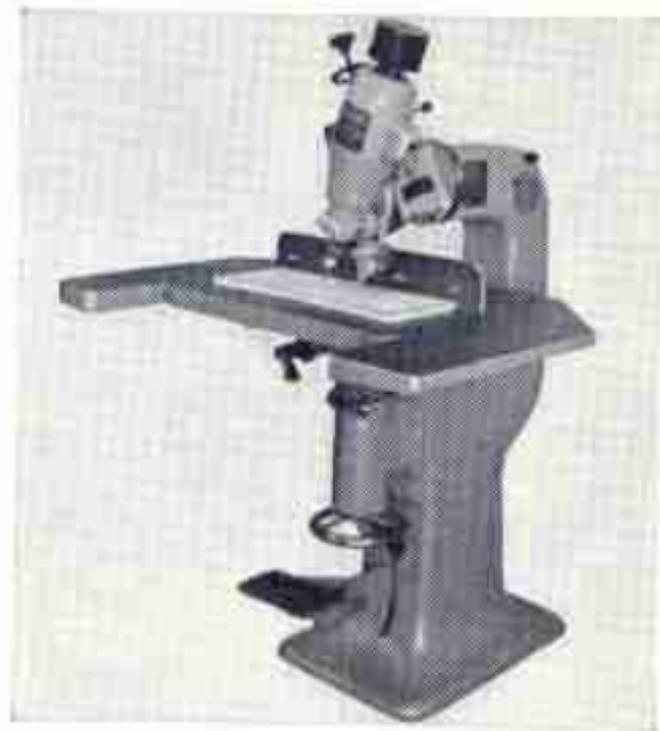
Universal-Oberfräse OFC mit  $3\frac{1}{2}$ -bis 4-PS-Motor · Frässupportschlitten um  $45^\circ$  neigbar · Fräskopf um  $360^\circ$  schwenkbar
