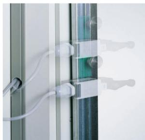
Mit dem **verstellbaren Endschalter** kann die Pressraumöffnung ganz einfach variiert werden. Der Endschalter ist mechanisch auf einer Laufschiene verstellbar.
