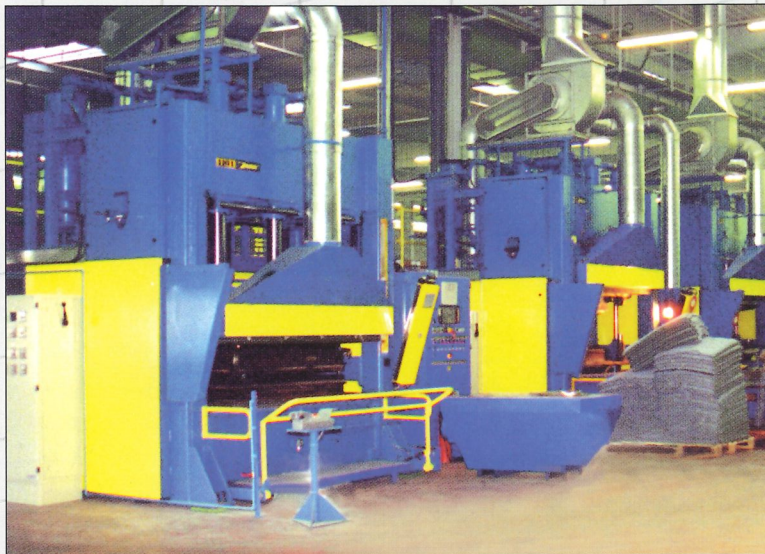
Joos-Qualitäts-Pressen HPS 250/OK in der Produktion von Verkleidungen, Hutablagen und Mittelkonsolen für die Automobilindustrie.
