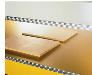
Zur **Kapazitätserweiterung** können alle HP-Modelle mit zusätzlichen Etagenheizplatten ausgestattet werden. Auf Wunsch wird die Joos-Qualitäts-Presse so vorbereitet, dass die spätere Erweiterung ohne große Mehrkosten möglich ist.
