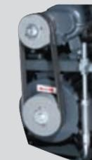
Die automatische Nachspannvorrichtung des Keilriemenantriebs sorgt für gleichbleibend guten Übertragungswirkungsgrad und besonders hohe Zuverlässigkeit des gesamten Antriebssystems.
