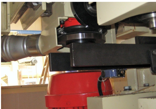
„Fliegender“ Fasemesser oben, 2-seitig abtastend
