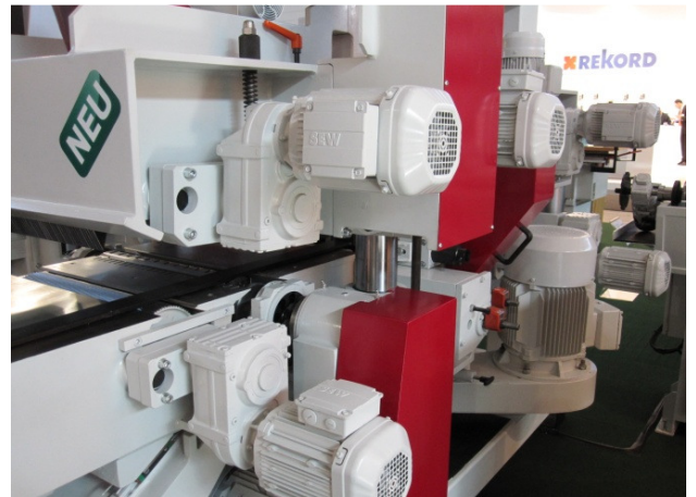
Jede Vorschubwalze einzeln mit Direktantrieb
