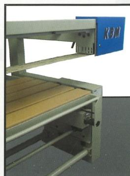
Die Langband-Schleifmaschinen LA 2500 / 3000 sind serienmäßig mit Bandantrieb 4 kW, großen Bandscheiben und Kröpfung rechts, 1000 mm tief ausgestattet. Die Maschinen können auch in verkürzter Ausführung und mit variablem Bandantrieb geliefert werden (Aufpreis). Maschinen in CE-Ausführung und staubgeprüft.
