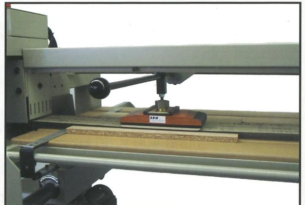
Serienmäßig mit hochwertigem Schichtholz-Schleifschuh 300 mm, mit Schnellklemmung und Schleifschuh-Schnellaustausch. Auf Wunsch Schleifschuh 450 mm lieferbar.
