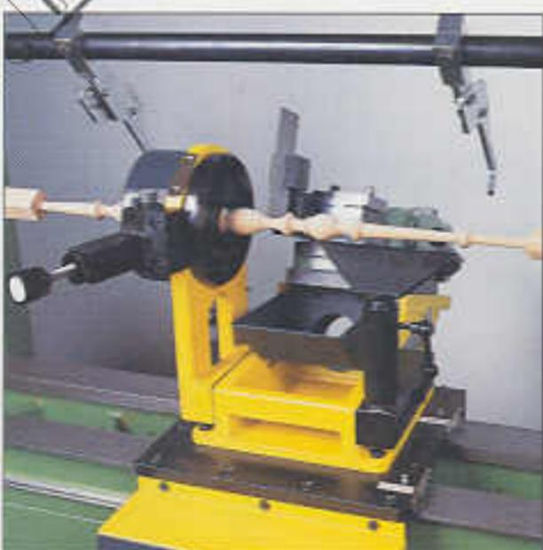
**WERKSTÜCK-EINLEGE- und -ZENTRIERVORRICHTUNG** – weggeschwenkt. V-Form-Kopierstahl mit Stahlhalter. Handauflage 170 mm am Bettschlitten montiert zum Nachstechen.
