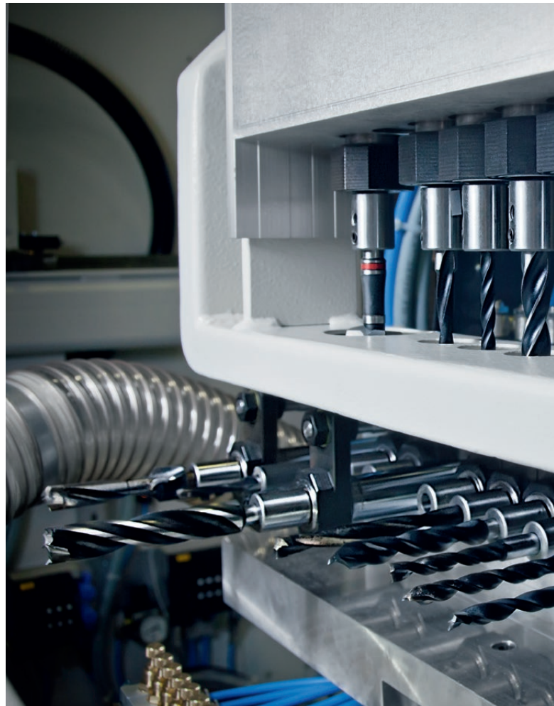
Bohrstation mit 7 vertikalen und 10 horizontalen Bohrspindeln Drilling station with 7 vertical and 10 horizontal drilling spindles
