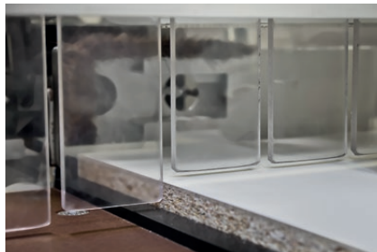
Eingreifschutz: Lamellenschutzvorhang Protection: Safety curtain with lamellas
