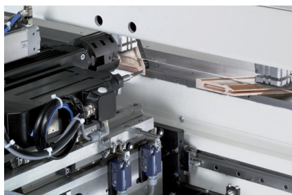
Horizontales Fräsen: Schlitz- und Zapfenbearbeitung für Rahmenteile (SPRINT-MT)
