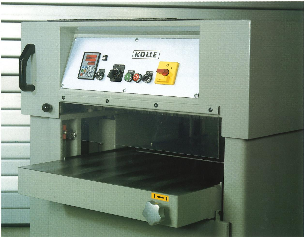
Bereits in der Grundausstattung mit elektronischer Positioniersteuerung für den Dickentisch und einem ergonomisch angeordnetem Bedienpult.
