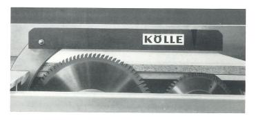
Die Vorritzkreissäge wird gegen Mehrpreis eingebaut. Das zweiteilige Ritzkreissägeblatt ist genau auf die Schnittbreite des Hauptkreissägeblatts eingestellt. Die Vorritzkreissäge schneidet unten im Gleichlauf ca. 2 mm tief vor und verhindert dadurch Ausrisse an der Unterseite von beidseitig beschichteten, belegten oder überfurnierten Platten.
