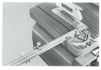
Der Queranschlag in Aluminium-Ausführung wird in der Prismanute des Maschinentisches geführt. Das 1150 mm lange Anschlaglineal ist nach beiden Seiten bis 60° schrägstellbar und kann bei Winkelschnitten zum Kreissägeblatt hin verstellt werden. Mit dem Queranschlag werden ein Ablänganschlag und eine Werkstückauflage geliefert.
