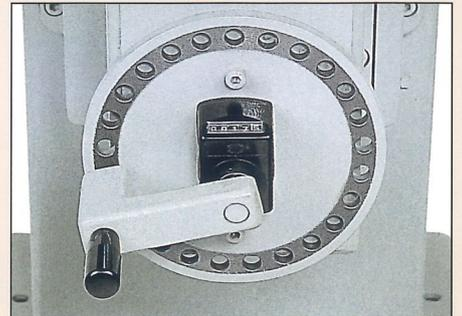
Die Bohrhöhe wird mit der Handkurbel nach der digital-mechanischen Maßanzeige auf 0,1 mm genau eingestellt. Damit können auch Bohrungen in mehreren Ebenen wiederholgenau gefertigt werden. Zur Fixierung der eingestellten Bohrhöhe wird der Griff der Handkurbel in die Lochscheibe eingerastet.
