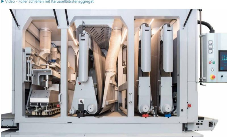
Weitere Anwendungen des Karussellbürsten-Aggregats sind das Ausschleifen von Füllungen bis hin zum Zwischen- oder Lackschleif und das gleichmäßige Brechen von Werkstückkanten.
