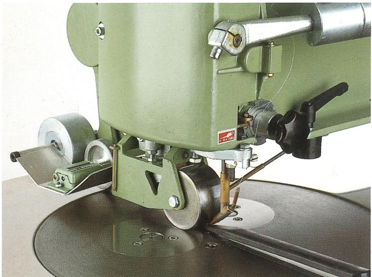
FW-Maschinenausschnitt mit Arbeits-tisch, mit Diskusscheiben, Druckrolle, Fadenführer, Niederhalter, Meterzähler und Abreißrolle.
