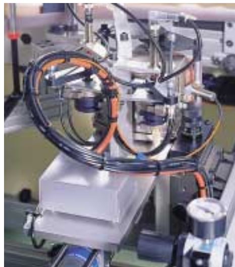
Prägekopf mit Infrarot-Heizsystem und Prägeradjustierung Stamping head with infrared heating system and head adjustment
