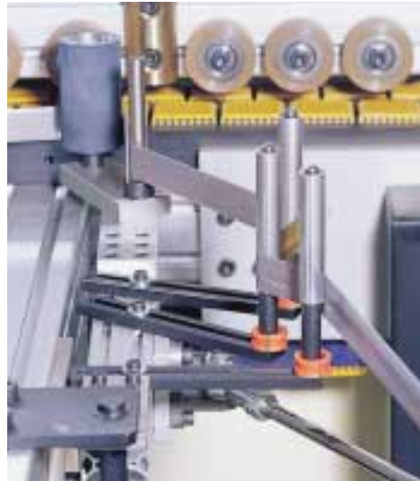
Folienaufwickler mit Folienführung Foil winder with foil guide
