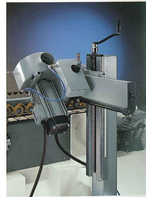
Particolare del gruppo ruota abrasiva con automatismo per il recupero del consumo. Abrasive wheel group with automatic compensation with timer. Détail du groupe roue abrasive avec automatisme de compensation d'usure. Scheibenschleif-Aggregat mit automatischer Zustellung. Particularidad del grupo abrasivo con rueda abrasiva con automatismo para la recuperación del consumo.
