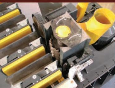
Die Werkstücke werden aufrecht durch die Fräsmaschine gefahren um vertikale Zinken herzustellen. Die Einheiten der Horizontalzinkenfräsmaschine arbeiten mit liegenden Werkstücken.
