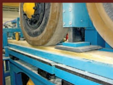
Die Servo positionierte fliegende Säge kann in allen Positionen schneiden und lässt sich somit für jeden Fall anpassen.
