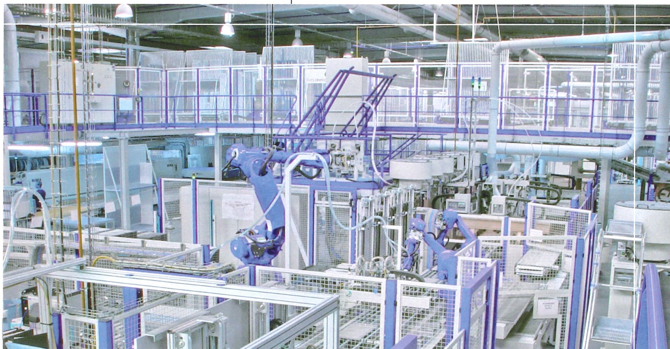
Linienintegrierte Fertigungszelle zum automatischen Setzen der Laufleisten.
