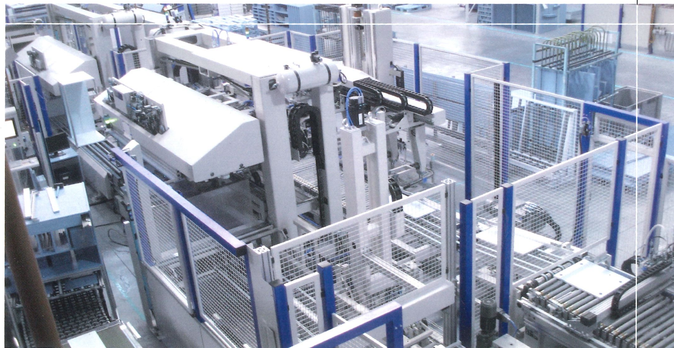
Zelle zum Fügen und Verpressen des Korpus.
