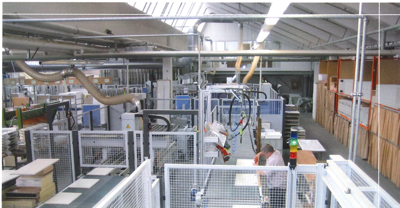
Korpuseiten und -böden werden in der Linie gebohrt. Sonderbeschläge werden manuell gesetzt.
