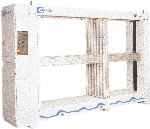
Die Ligmatech-Pressen MPH 40 ist eine flexible Korpuspresse für den Handwerksbereich, aber auch für die Sonderfertigung in der industriellen Möbelfertigung. Sie besteht aus einer verwindungsfreien Rahmenkonstruktion.
