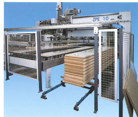
Abstapelung von Arbeitsplatten an einer Friz-Kaschieranlage
