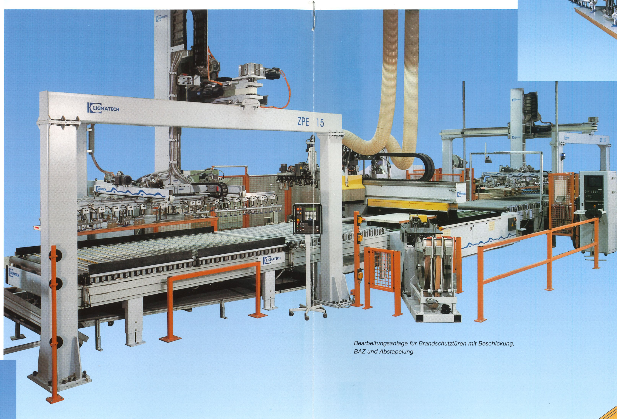
Saugtraverse, die sich auf die Breite und die notwendigen Teileausschnitte automatisch rüstet.
