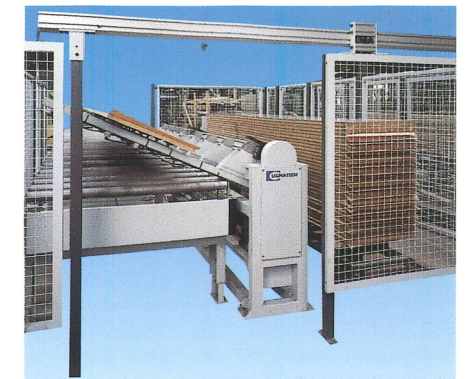
Beschickung einer Homag-Postformingmaschine mit Wender
