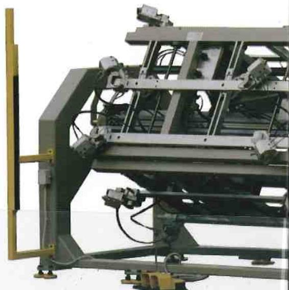
Strettoio per l'assemblaggio di ante a telaio con giunzioni a 45°.
