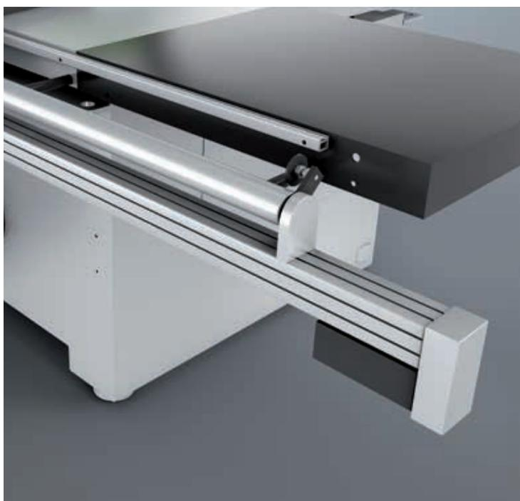
+/- 1/10 – das ist die Positioniergenauigkeit des Anschlags. Eine staubgeschützte Kugelumlaufspindel im Zusammenspiel mit einem Motor übernimmt diese Aufgabe. Schnell und zuverlässig. Und sollte doch mal etwas ausfallen, können Sie unseren Anschlag problemlos auch manuell nutzen. Die Skala im Maschinentisch und bekannte Bedienelemente garantieren eine unkomplizierte Handhabung.
