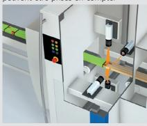
Grâce à un système de convoyage développé spécialement pour nos scanners le positionnement des défauts est très précis, même à haute vitesse.
