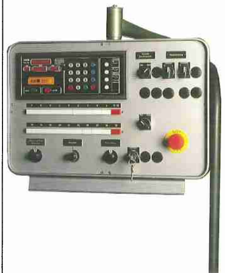
Positioniersteuerung mit 99 Massspeichern, mit wählbarer Anzahl direkt abrufbarer Fixmasse. Auch Kettenmasse sind frei programmierbar.
