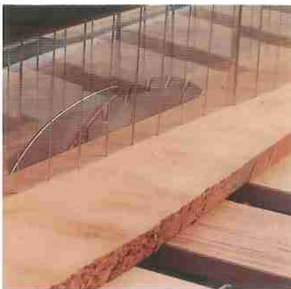
Plastiklamellen schliessen staubdicht ab.
