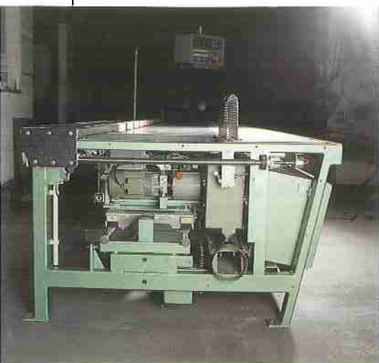
Stahlrahmenkonstruktion, Minihydraulik mit absenkbarem Kreissägeblatt und Spindelverstellung des Breitenanschlages.
