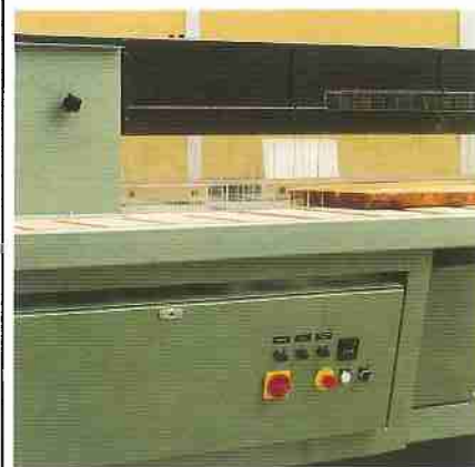
Zwischen Absaugbalken und Arbeitsfläche bleiben 250 mm lichte Höhe.
