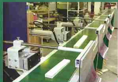
Sortierband mit Auswerfstationen
