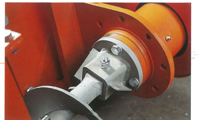
PENDEL - SCHNECKENLAGERUNG unempfindlich gegen grössere Brennstoffstücke, da die Schnecke im Rohr ausweichen kann
