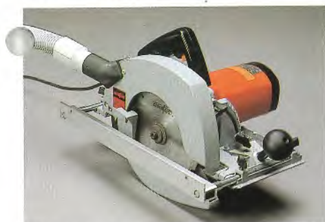
AS 1000 mit Handkreissäge MKS 55 (auch zum Anschluß an MKS 65–125 geeignet)
