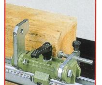
Das 3 Meter lange Anschlagprofil mit mm-Skala sowie der Längenanschlag ermöglichen präzises Positionieren der Werkstücke.
