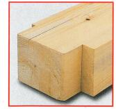
Ob gerade oder schräge Zapfen, die Steuerung ermöglicht eine 4-seitige Bearbeitung in einem Arbeitsgang. Damit sind alle Zapfen auch ringsum angefast.
