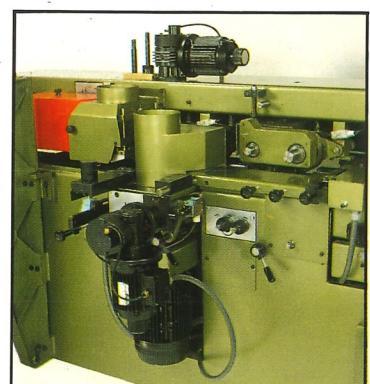
La macchina è fornita di serie con un sistema di traino completamente rigido a riduttori e cardani così come di motovariatore. Per facilitare l'uscita del legno la macchina è munita di una coppia di rulli superiormente ed inferiormente al piano di lavoro.
