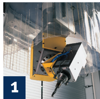
1 Unité de fraisage Broche standard avec interface HSK F 63. D'autres broches sont disponibles en option
