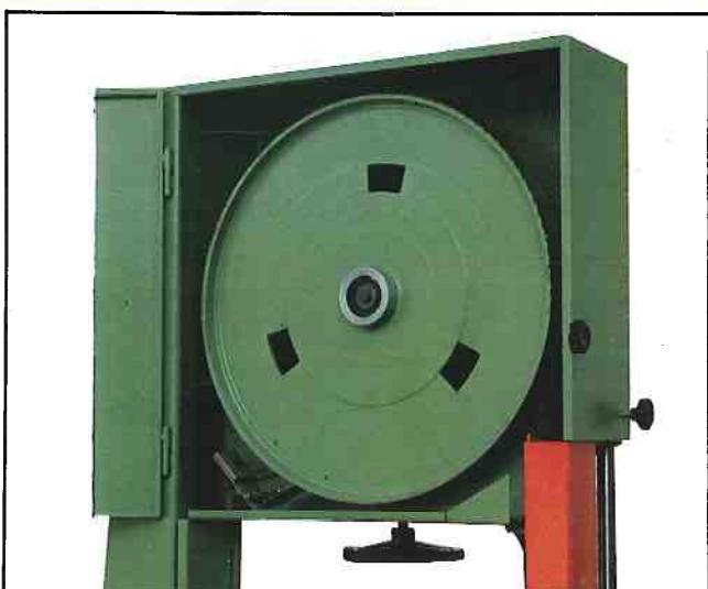
**F** La protection intégrale de la lame (ou télescopique) et les deux guide-lames à inserts permettant une bonne direction du ruban, sont de série.
