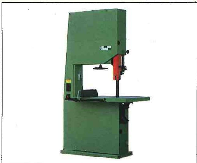
**I** La lubrificazione assicura un'ottima pulizia della lama mediante feltro imbevuto di gasolio contenuto in un serbatoio. Lo scivolo in legno assicura una buona aspirazione della segatura. I raschianti con lama in ottone permettono un'ottima pulizia dei volani ed assicurano un buon lavoro della lama.
