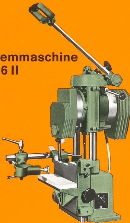
Robuste 1,3-kW-Tischmaschine zur schnellen Herstellung rechteckiger Stemmlöcher. Einsatzbereich für Schlitz bis ca.  $12 \times 50 \times 50$  mm. Aggregat bis  $30^\circ$  drehbar.
