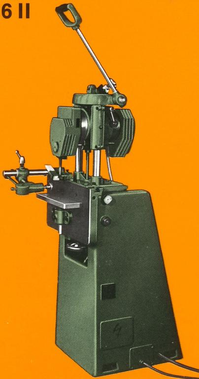
Robuste 1,3-kW-Ständer-Stemmaschine zur schnellen Herstellung rechteckiger Stemmlöcher. Einsatzbereich für Schlitz bis ca.  $12 \times 50 \times 50$  mm. Vielseitig einsetzbar. (Beispiele: Einlassen von Fischen-Bändern, Gestellfertigung, Sitzmöbelherstellung, Stemmen von Leiternholmen.) Aggregat schwenkbar für vertikale und horizontale Arbeitsweise. Werkstückauflage neigbar.
