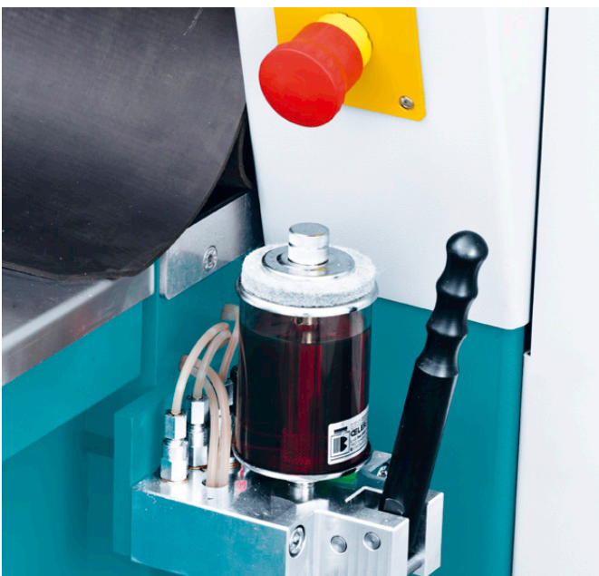
Zentralschmierung über Ölpumpe
