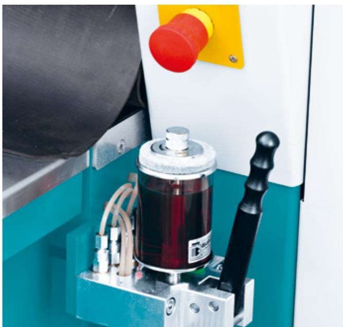
Lubrificazione centralizzata mediante pompa dell'olio
