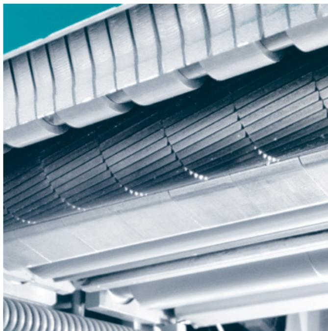
Rullo di inserimento di acciaio con dentatura a spirale
