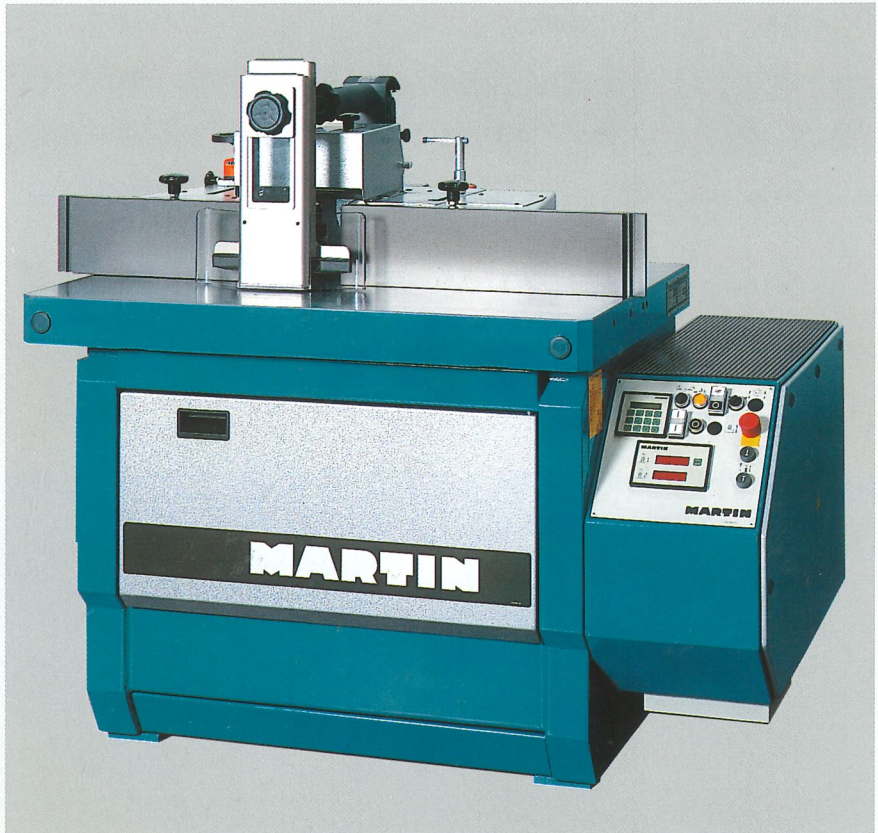
MARTIN Starrfräse T 20 mit Schutzvorrichtung Centrex T 2000 und der stufenlosen Drehzahlregelung T 2003
