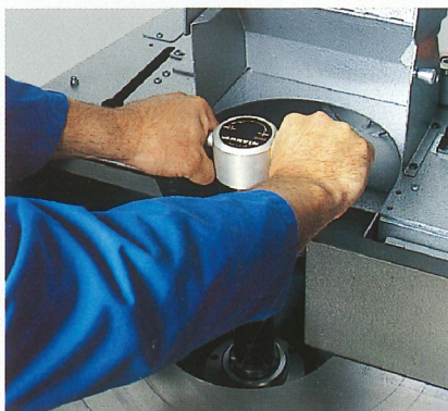
Schnellwechsel des Fräsdorns mit dem Drehmomentschlüssel
