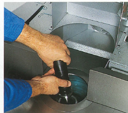
Präzise – Fräsdorn mit Steilkegelaufnahme SK 40
