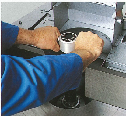
Schnellwechsel des Fräsdorns mit dem Drehmomentschlüssel
