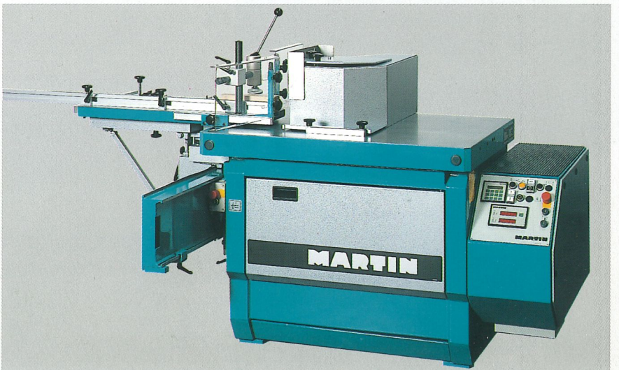
Starrfräse T 20 mit Schiebeschlitzen T 2080, Centrex-Schutz T 2000 und der stufenlosen Drehzahlregelung T 2003
