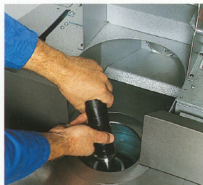
Précision - Mandrin avec coussinet cône à angle obtus SK 40
