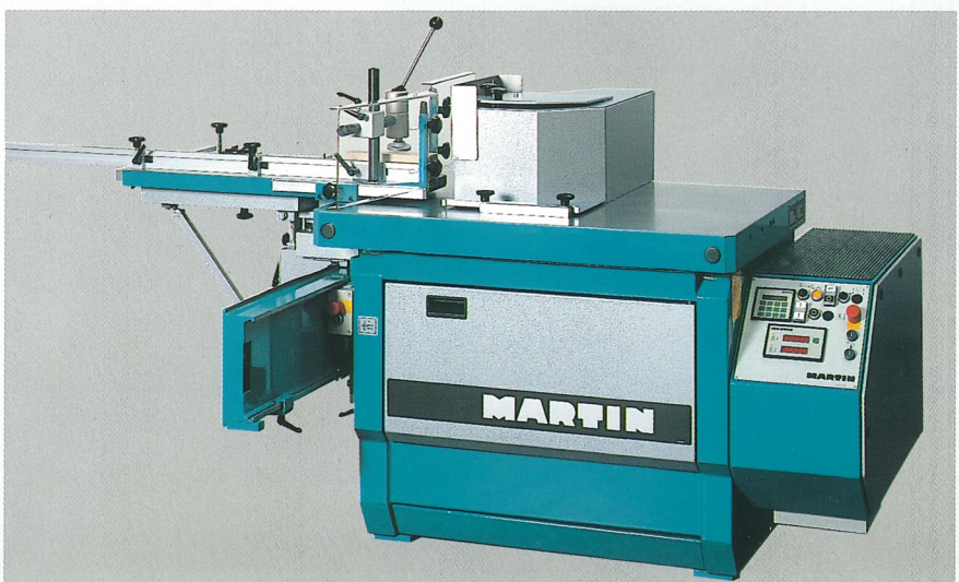
Toupie à arbre fixe T 20 avec table à tenonner T 2080, Protecteur type Centrex T 2000 et Réglage de vitesse en continu T 2003
