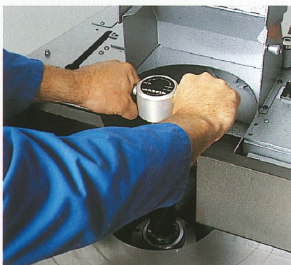
Changement rapide du mandrin avec la clé dynamométrique
