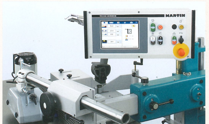
Elektromotorisch positionierbarer Vorschub-Support
