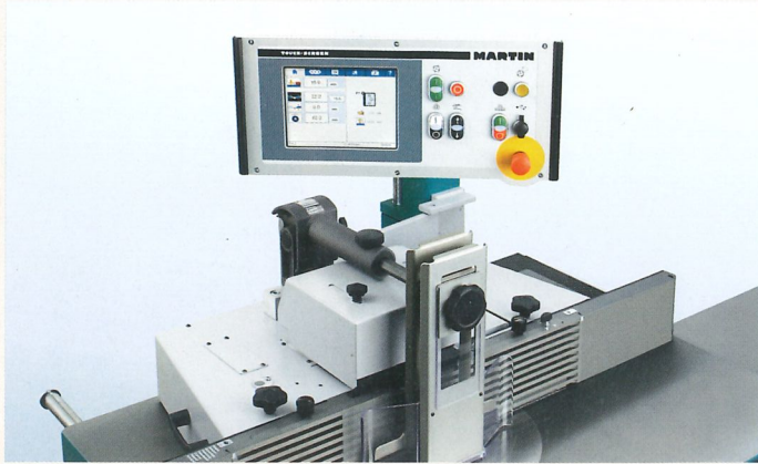
Elektronische Positionierung des Fräsanschlags
