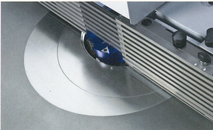
Elektromotorisch positionierbare Tischöffnung
