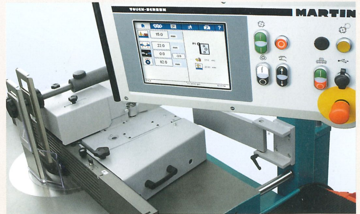
Elektromotorische Positionierung der Einlaufbacke
