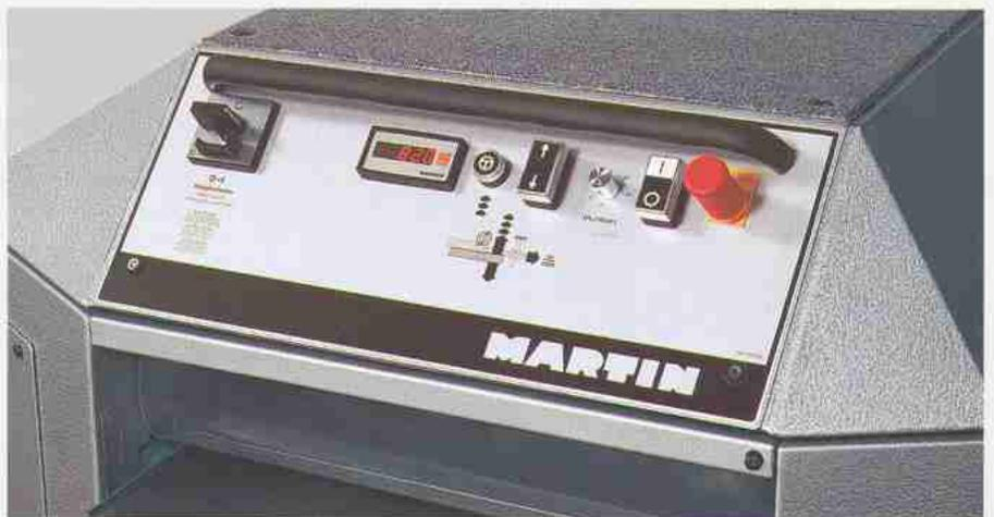
Schalttafel mit stufenloser Vorschubregelung T 445 (optional)
