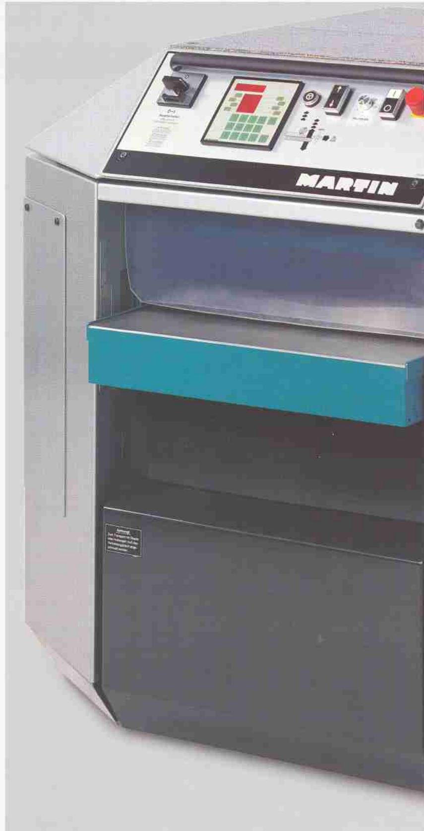
Dickenhobelmaschine T 44 mit stufenloser Vorschubregelung T 445 und Dickentischsteuerung T 446 A.
