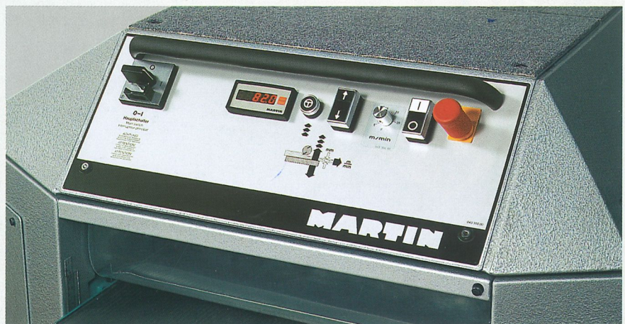
Betjeningspanel T 445 med trinløs regulering af fremføringshastighed (ekstraudstyr)
