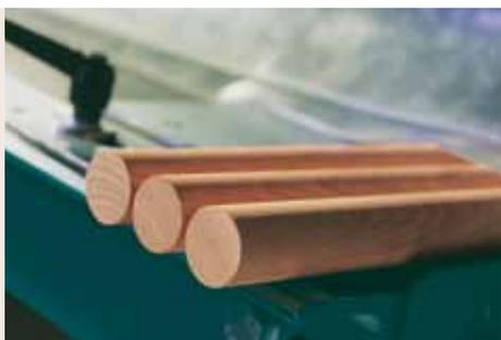
Готовые цилиндрические детали за два прохода
