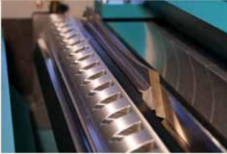
Цельнометаллический «Строгально-Калевочный» ножевой вал с двумя ножами TERSA и четырьмя с зубчатым креплением для профилирующих ножей T4505/4-а
