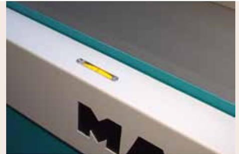
Хорошо считываемая шкала для снятия стружки
