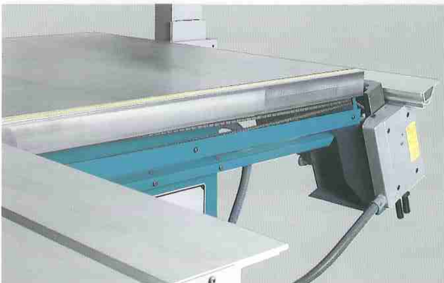
Das Kreissägelineal ist unter den Tisch geklappt.
