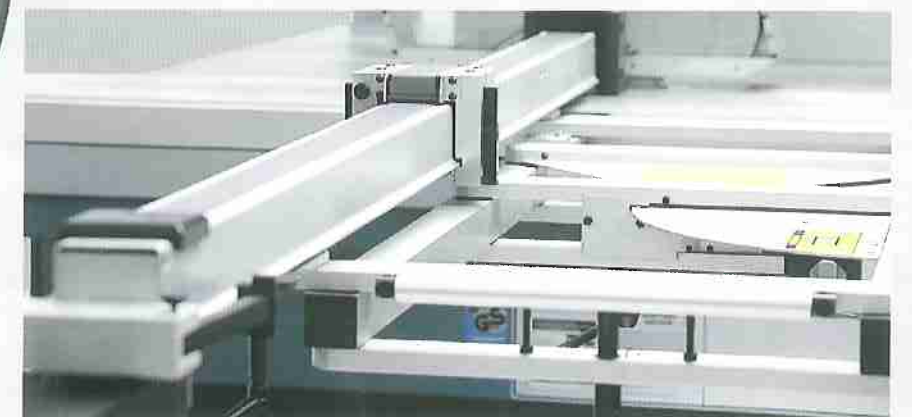
Die 4. Achse auf dem Parallelogrammtisch: Schneiden von Gehrungsmaßen gesteuert
