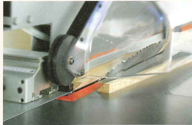
Coupes d'angles avec le dispositif de serrage pneumatique.
