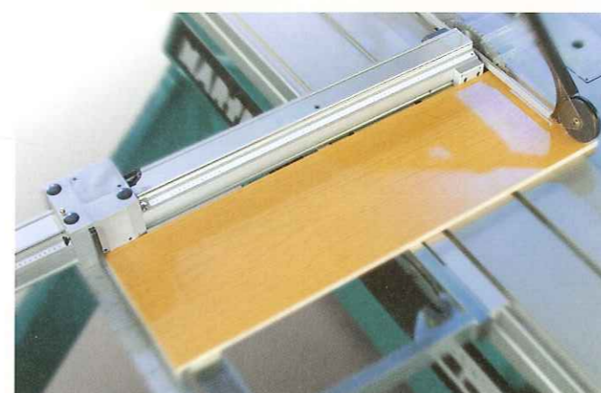
Butée de longueur standard sur réglet gradué avec appui à deux points
