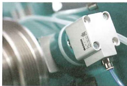
Blocage électro-pneumatique de l'arbre de la lame de scie
