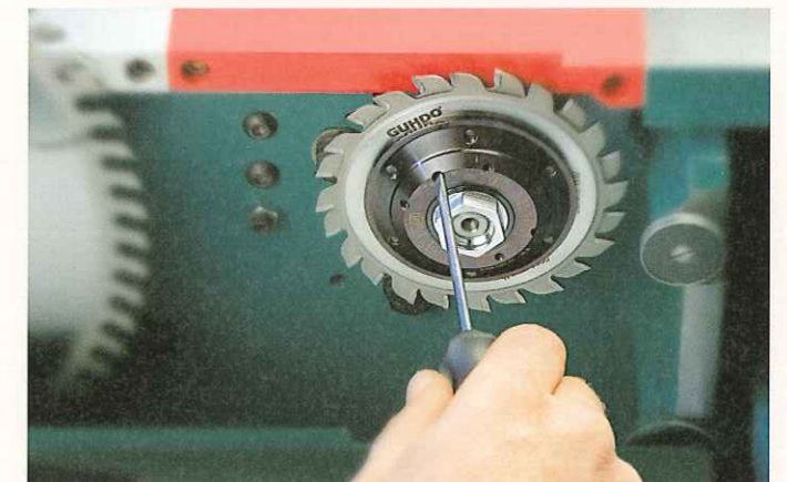
Système de lame traceuse „Ritzfix“ T 7322
