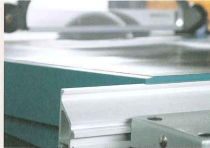
Automatisches Absenken des Kreissägelineals
