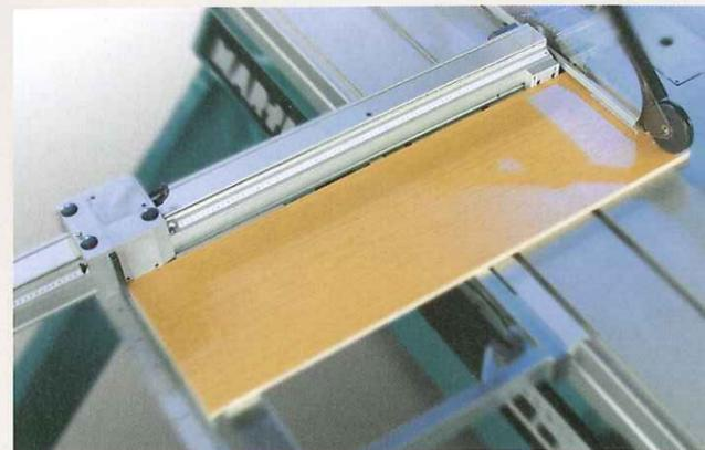
Standardmäßiger analoger Längenanschlag mit 2-Punktanlage
