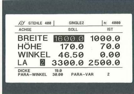
LCD-Display der T 73 CNC
