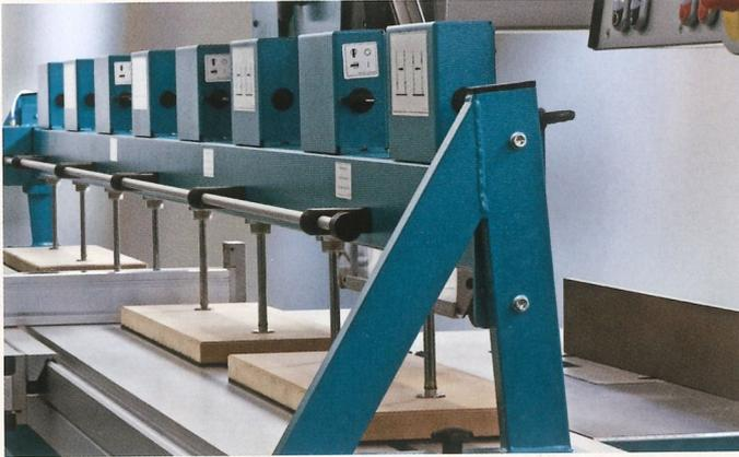
T7570/5-b Pneumatischer Druckbalken
