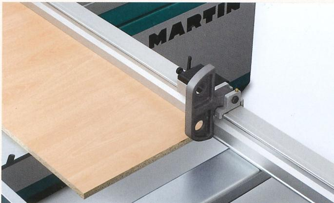
Analoger Längenanschlag mit durchgehender Anlage T7537
