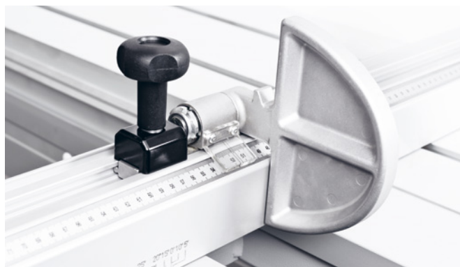
Compensation de longueur pour les coupes d'angle | Standard
