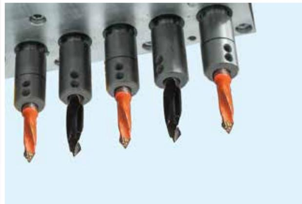
Сверлильная голова с независимыми шпинделеми для вертикального сверления (опц.)
